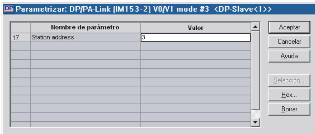
Figura 8-5 Entrada de la dirección PROFIBUS
