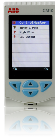
Fig. 3: Pantalla de estado de alarma
